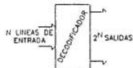
FIG. III.6 Diagrama a bloques del decodificador
