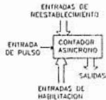
FIG. IV.7 Diagrama a bloques del contador asincrono.
