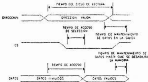
FIG. VIII.15 Tiempos de operación de la ROM
