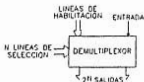
FIG. III.4 Diagrama a bloques del demultiplexor
