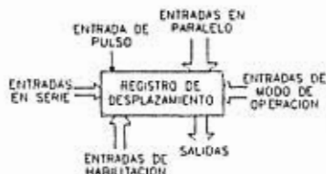
FIG. IV.10 Diagrama a bloques de un registro de desplazamiento
