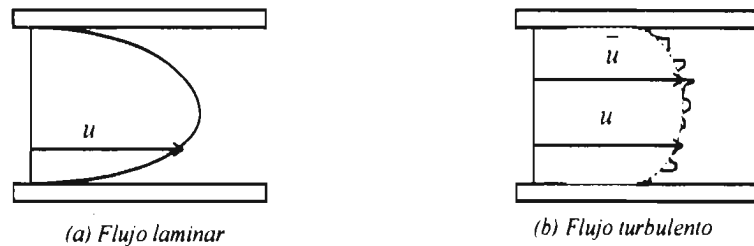
Ilustración 2.1 Flujos laminar y turbulento en un tubo.
