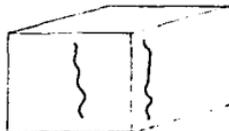
ESQUEMA DE FALLA EN LA MUESTRA
