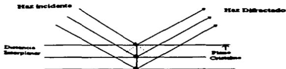
Figura 3. Difracción de rayos X a partir de los planos de un cristal
