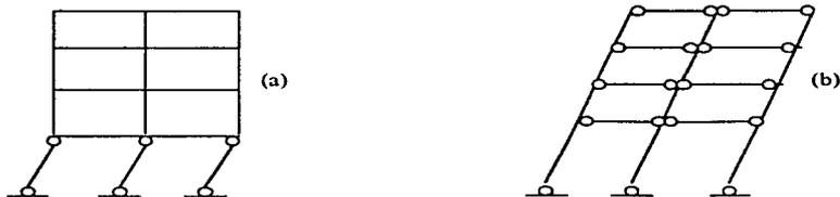
Fig 1.11. - Mecanismos de falla de columna y de viga
