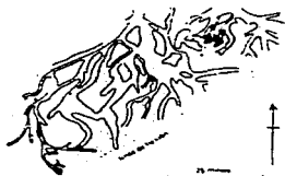
Fig 1-8. Mapa de isopacas de la arenisca Booch (Pensilvánico) de Oklahoma. Punteado fino: areniscas en mantos (0-6 m). Punteado grueso: canales (6-60 m). Véase cómo los campos petroleros (en negro) se concentran en las arenas de canal. Modificado por Bush, 1961.
