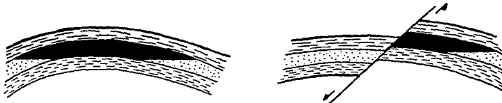
Fig IV-12 . Esquema que muestra trampas en anticlinales y contra falla.
