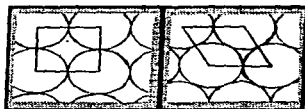
Fig III-14. Diagrama que ilustra el empaquetamiento cúbico con una porosidad aproximada de 47.64 % y el romboedral con porosidad de 26.9 %.
