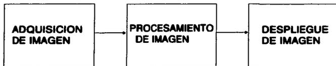
Figura 1-9. Los tres componentes básicos de un sistema de procesamiento de imagen.
