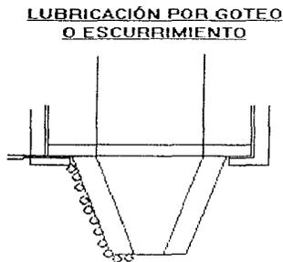
Fig. 4.28 Lubricación de boquilla por goteo o esguerrimiento
