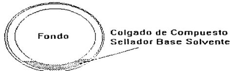
Fig. 8.15 Colgado de Compuesto Sellador Base Solvente en el canal del fondo
