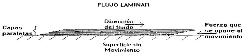
Fig. 7.1 Representación de un flujo laminar
