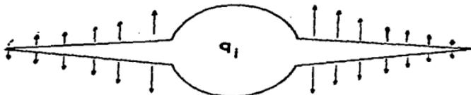
Fig. II. D) Comportamiento de la velocidad de pérdida en la cara de la fractura<sup>2</sup>
