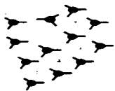
Figura 2. Representación esquemática de la estructura del vidrio.
