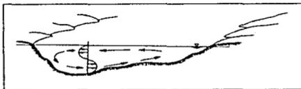
Definiendo el mezclado completo como el punto donde la concentración no varía más del 5% a través de toda la sección transversal del canal, el modelo para la determinación de la distancia longitudinal  $L$  (ver figura 3.2) en la cual se presenta esta condición, supone la propagación bidimensional de una pluma mezclada completamente en la dimensión vertical.
