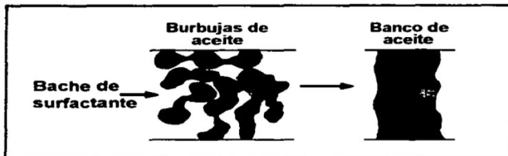
Figura III.13 Diagrama esquemático del papel de la viscosidad interfacial en el proceso de recuperación de aceite. <sup>(26)</sup>
