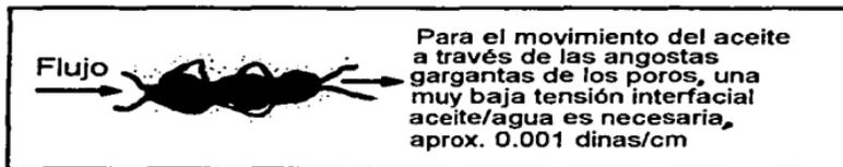
Figura III.14 Diagrama esquemático del papel de la tensión interfacial en el flujo de gotitas de aceite. <sup>(26)</sup>
