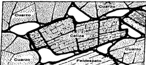
Figura III.1 Ilustración de la retención del fluido (agua) en los poros por adhesión y capilaridad. Todo el fluido (agua) que se drena libremente se ha evacuado de los espacios porosos más grandes. <sup>(17)</sup>
