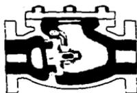
Válvula de retención convencional de obturador excéntrico
