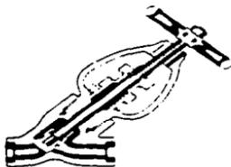
Válvula de globo, modelo en Y, con vástago a 45°
