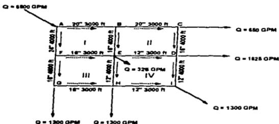
En este arreglo se debe estimar el flujo que pasa a través de cada tubería, considerándola de acero al carbón con un coeficiente C de 120.
