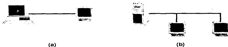
Fig. 5 Topologías Punto a Punto (a) y Multipunto (b).
