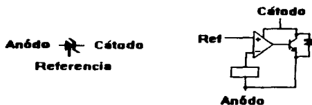
Figura 6.17 Símbolo y esquema del regulador programable ajustable TL431.
