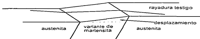
Figura 1.6: Efecto de una raya testigo del relieve de la superficie debido al surgimiento de una plaqueta de martensita [2].
