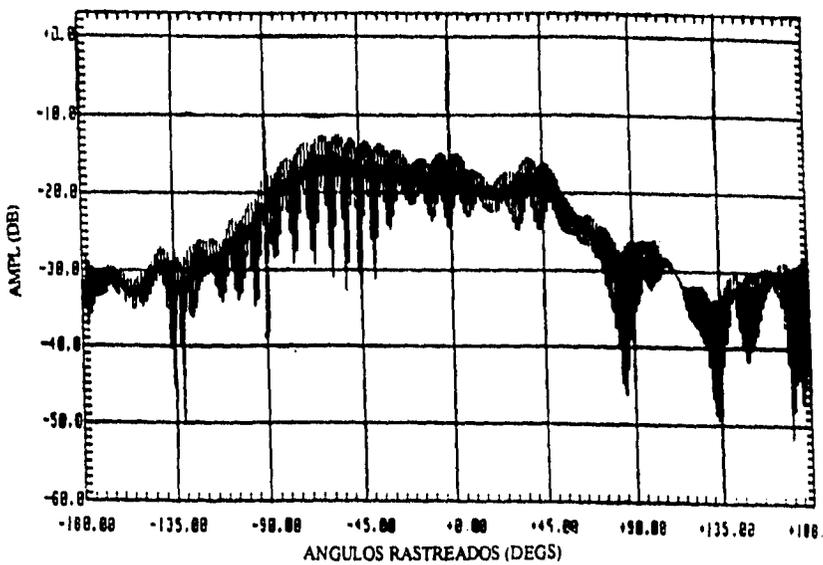
Figura 4.4.42 Medidas del patrón de una antena helicoidal de 4 brazos a 1.575 GHz
