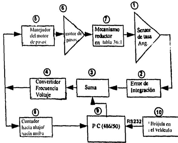
Figura 4.3.1 Diagrama de bloques de un sistema de antena rastreadora móvil.
