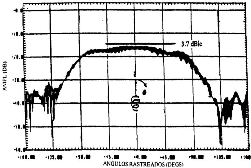
Figura 4.4.40 Medidas del modelo de la antena helicoidal de 4 brazos.
