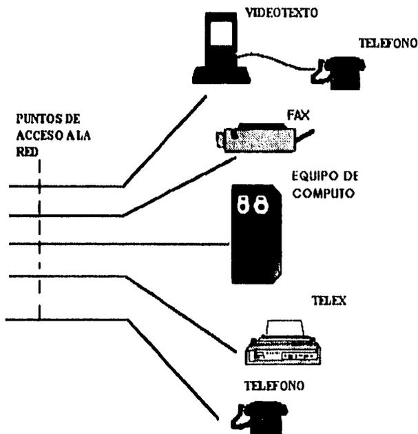
Figura 2.2.2. Accesos separados para los diferentes tipos de redes
