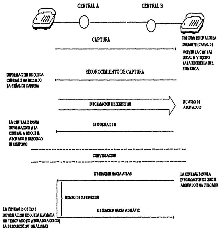
FIGURA 2.5.1 Señalización entre centrales
