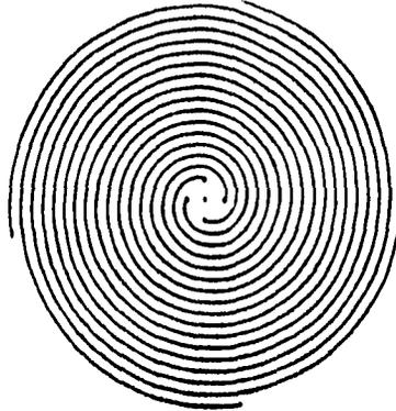
Figura 4.4.4 Configuración de una antena en espiral de 4 brazos
