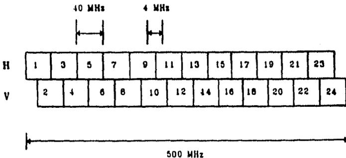
Figura 1.3.3 La distribución en bandas de un transponder.
