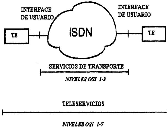
Figura 2.2.5. Relación de los servicios de transferencia y los teleservicios con el modelo OSI
