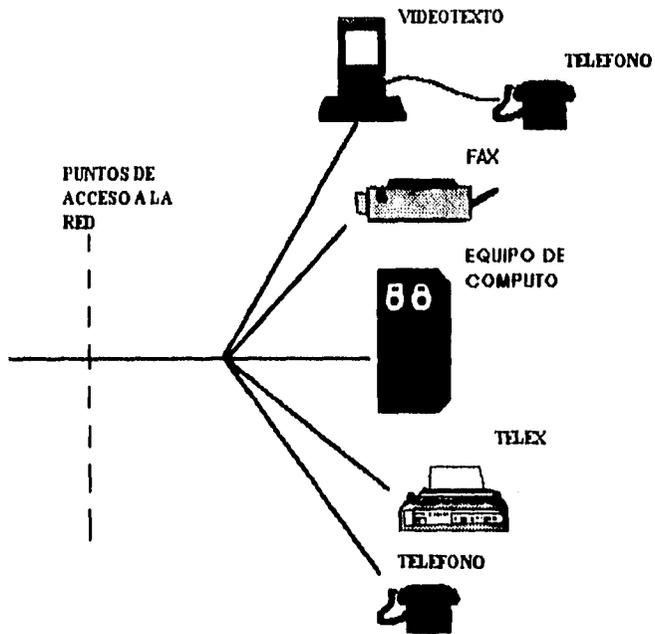
Figura 2.2.3. Acceso integrado a través de una simple línea de abonado
