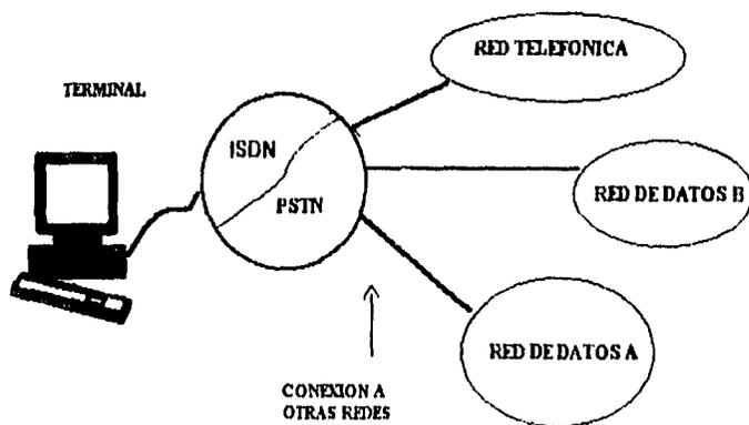
Figura 2.2.4. La ISDN sirve también como interface a otras redes específicas
