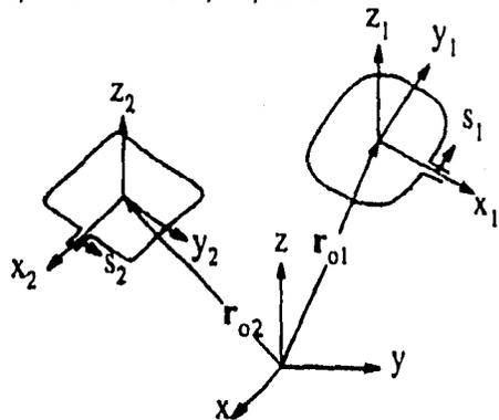
Figura 4.4.30 Geometría de dos pares de circuitos de antenas mostrando sus coordenadas.
