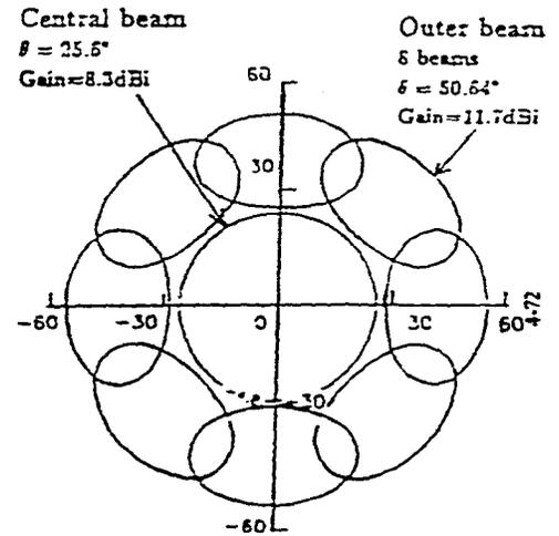
Figura 4.5.6 Cobertura de las señales que conforman el arreglo de la antena.
