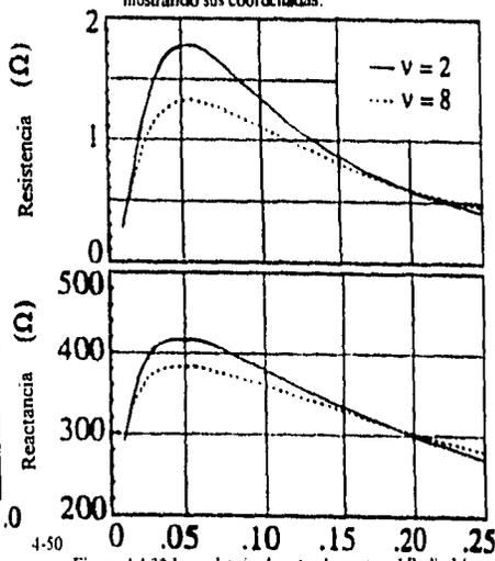
Figura 4.4.32 Impedancia de entrada contra el Radio  $b/a$  para 0.25λ de circuito con Omega igual a 10 para dos valores de v.
