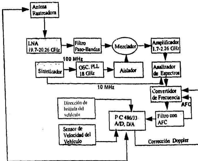
Figura 4.3.2 Diagrama de bloques de un sistema de receptor móvil.
