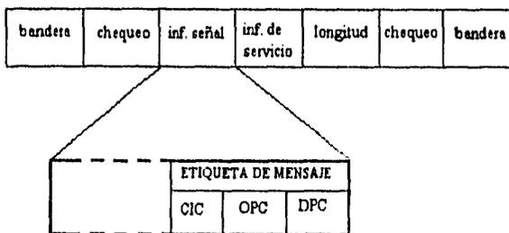
FIGURA 2.5.4. Estructura del MSU
