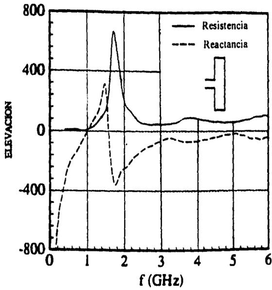
Figura 4.4.36 Resultado de la entrada de la impedancia FDTD contra frecuencia para un rectángulo cerrado, con  $a = 0.86$  cm;  $b = 2.56$  cm;  $r_w = 0.75$  mm, cargado con un circuito abierto.
