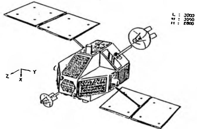
Figura 4.5.8 Configuración de las antenas montadas en el LEO-SAT.
