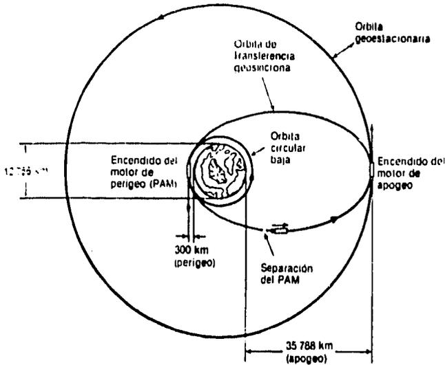
Figura 1.1.4 Los orbitadores de la NASA colocan al satélite en una órbita circular baja. Para que éste llegue a su posición geoestacionaria final deben seguirse otros dos pasos, mediante el encendido de un motor de perigeo y después el de un motor de apogeo.
