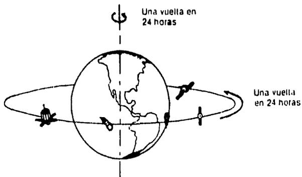
Figura 1.1.2 Los satélites geostacionarios giran alrededor de la tierra sobre el plano ecuatorial, completando una vuelta en 24 horas.
