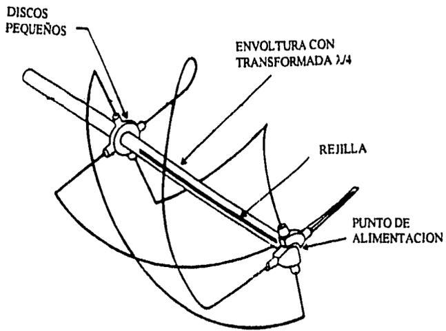
Figura 4.4.37 Configuración de una antena helicoidal de 4 brazos.
