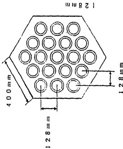
Figura 4.5.1 Constitución de los alimentadores de la antena de arreglo planar de apertura circular.
