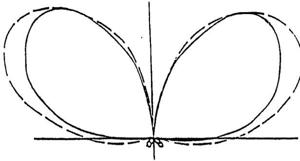
Figura 4.4.39 Modelo típico de la figura de Dona en una antena espiral cónica.
