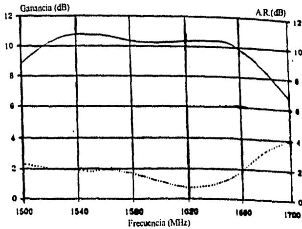
Figura 4.4.26 Ganancia y variaciones de Radio Axial vs. frecuencia de la antena, aislada desde el Plano de Tierra.
