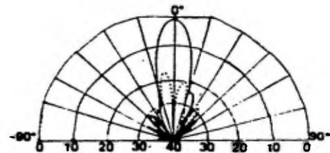
Figura 4.4.16 Patrón del Azimut, 30 GHz, Co y X-pol.
