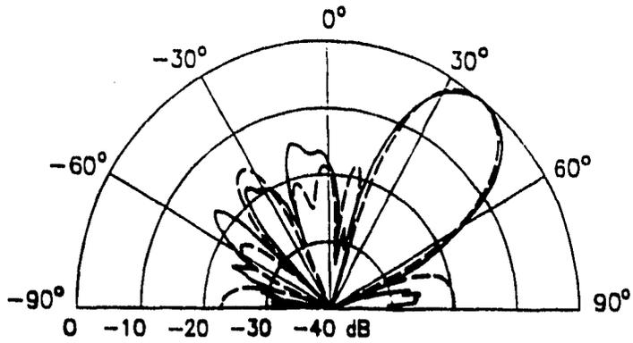
Figura 4.4.21 Modelo de elevación de un arreglo lineal del slot.
