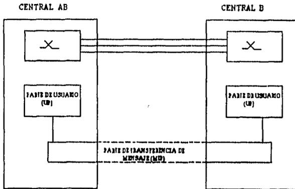
Figura 2.5.2. Parte de transferencia de Mensaje
