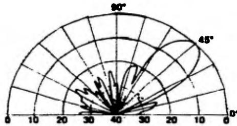
Figura 4.4.13 Patrón de Elevación, 20 GHz, Co y X-pol.
