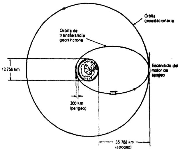
Figura 1.1.3 Algunos cohetes, como los Ariane de la Agencia Espacial Europea, colocan a los satélites geostacionarios en dos pasos. El satélite se pone primero en una órbita elíptica de transferencia geosíncrona y después de varias vueltas, en uno de los apogeos se enciende un motor que circulariza la órbita, quedando así el satélite en órbita geostacionaria.
