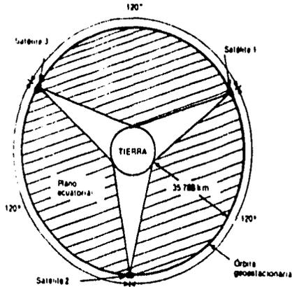
Figura 1.1.1 Clarke indicó que con solamente tres satélites en órbita geostacionaria sería posible intercomunicar por radio a casi la totalidad del mundo.
