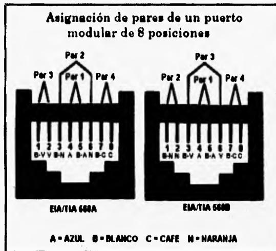
**Figura 3.25.** Asignación de pares de un puerto modular de 8 posiciones
