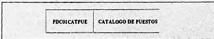
Figura 35.14 Identificación descriptiva de almacenadores en un DFD.
