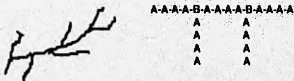
Fig. 4.2. DISPOSICIÓN MOLECULAR DE POLÍMEROS: RAMIFICADA.
