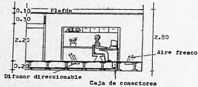
Con el cambio de posición de una placa en la cual se localice una rejilla de aire, se tendrá el servicio donde se requiera, dándole flexibilidad a las instalaciones.
