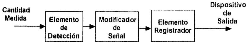
Figura I.5.1 Diagrama de bloques de un transductor
