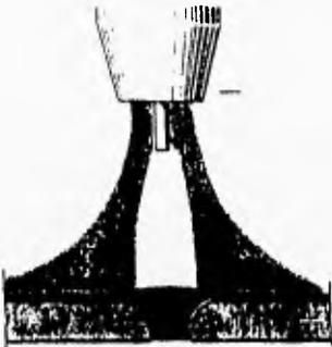
LA CORRIENTE CONTINUA CON POLARIDAD DIRECTA PRODUCE PENETRACIONES PROFUNDAS DEBIDO A QUE CONCENTRA EL CALOR SOBRE LA PIEZA
