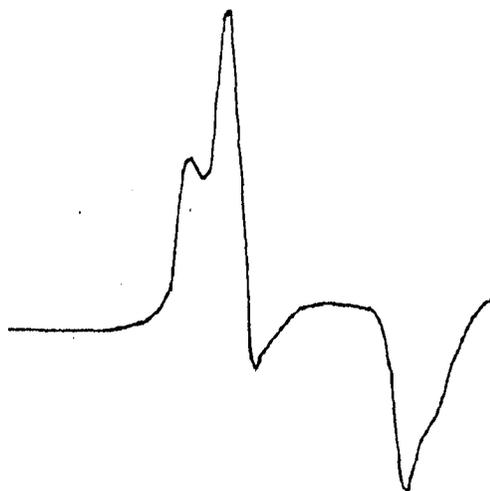
**Fig. 4.7.- Cromatograma de permeación en gel del polímero de neodimio, compuesto (1). El tiempo de permeación (minutos) va de izquierda a derecha y de menor a mayor tiempo.**
