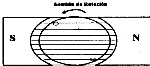
Figura 4.3. El alternador elemental consiste en una sola bobina montada en una armadura de hierro que gira en un campo magnético uniforme. El voltaje inducido por la bobina es proporcional al ritmo con que se cortan las líneas de fuerza del flujo magnético.
