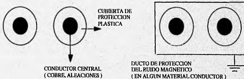
**CORTE DE UN PAR DE CONDUCTORES**
