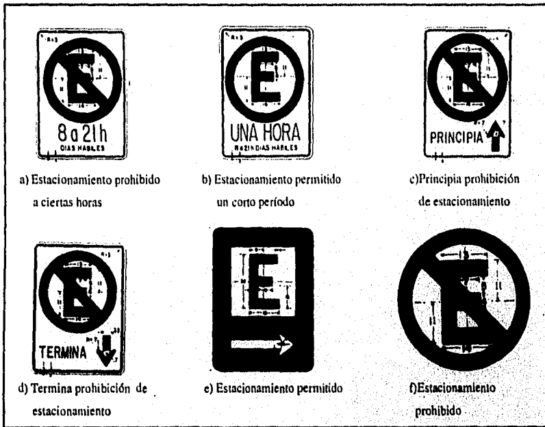
Figura 1.1.3 Señales de control de estacionamiento para las calles.
