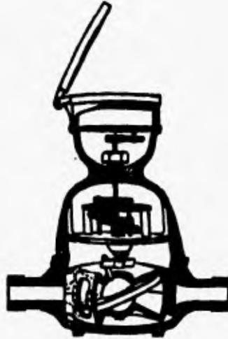
Figura 1.1 Medidor de disco nutatorio
