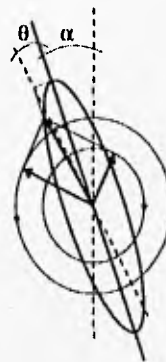
Figura 33. Luz polarizada elípticamente, construida por dos rayos de luz polarizada circularmente de diferente magnitud.
