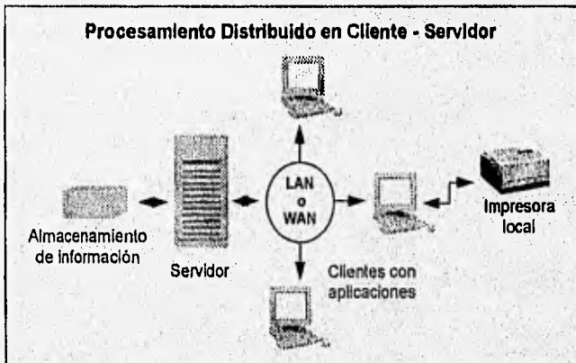
Gráfica 1.7 En este esquema se muestra el procesamiento distribuido cliente-servidor
