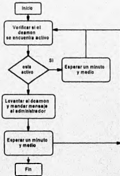
Diagrama de flujo del monitor para los servicios World Wide Web y FTP
