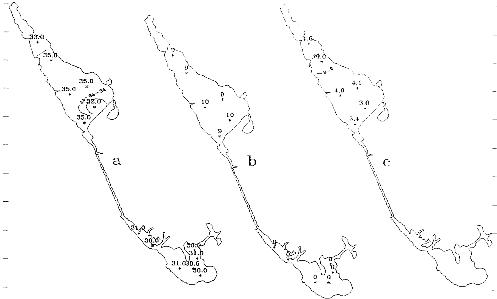
FIGURA 5.- COMPORTAMIENTO DE: a) LA TEMPERATURA ( ^{\circ}\text{C} ), b) LA SALINIDAD (ppm) Y c) EL OXIGENO DISUELTTO (ml/l) EN EL SISTEMA DURANTE AGOSTO DE 1993.
