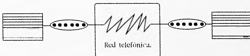
Figura 6.1. Comunicación en red por módem vía X.25
