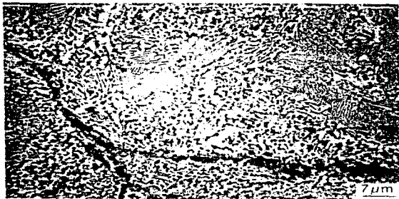
Fotografía 9 Microestructura del Zinc en polvo consolidado sin sinterizar; se observan regiones con perlita fina y otras con estructura de granos finos, se puede ver también los bordes entre las partículas de polvo.
