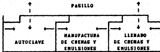
FIGURA 3. Representación de la presión diferencial.
