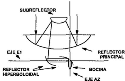
**Antena Gregorian.** La antena Gregorian es el tipo de reflector dual, en donde se observa que hay un reflector primario parabólico y un subreflector de forma elíptica. El punto focal  $F_1$  del paraboloide es compartido por el elipsoide, como uno de los focos. En el otro foco  $F_2$  del elipsoide, se coloca el radiador primario. A diferencia de la antena Cassegrain, ésta tiene un foco real  $F_1$  donde son enfocados todos los rayos.
