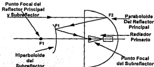
**Antena Cassegrain Modificada.** La antena Cassegrain que tiene un reflector de bocina como radiador primario es llamada antena Cassegrain Modificada. El alimentador cónico de la antena tipo Cassegrain ha sido sustituido por un alimentador de bocina, con lo cual la antena resultante cuenta con las ventajas principales de la primera y además, se mejora el acceso a los sistemas de recepción con la bocina.
