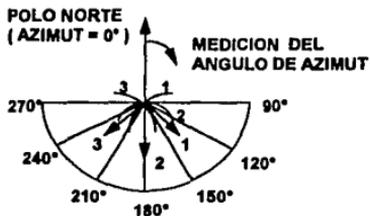
DEFINICION DEL ANGULO DE AZIMUT DE LA ANTENA DE UNA ESTACION TERRENA, SE MUESTRA TRES ORIENTACIONES DISTINTAS DEL PLATO PARABOLICO; LAS FLECHAS INDICAN LA DIRECCION DE MAXIMA RADIACION PARA CADA CASO.
