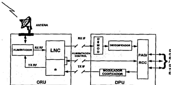
\* CONVERTIDOR DE SUBIDA Y AMPLIFICADOR DE POTENCIA
