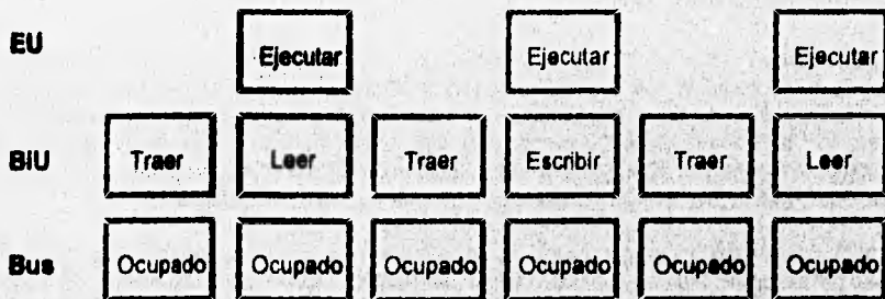
Figura 2.3 Los Microprocesadores 8086 y 8088 Indicando el Nivel de Actividad de su Bus
