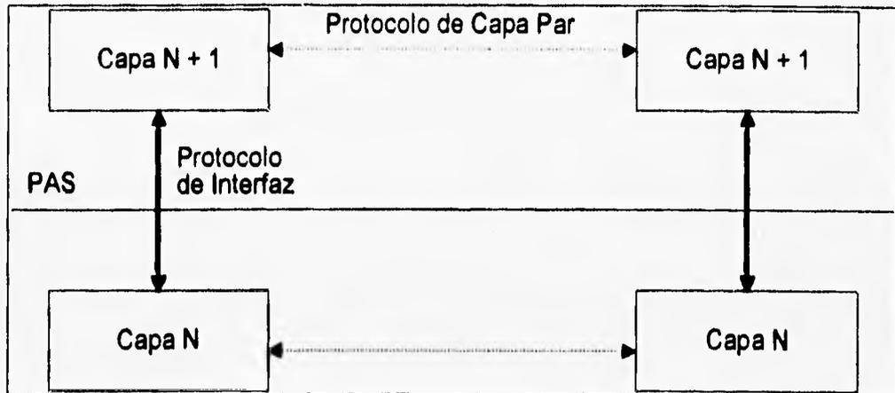
Figura II.4-3. Protocolos de interfaz y de entidades pares en el modelo de referencia OSI.
