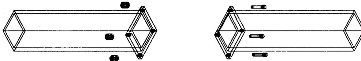
Las uniones de los PTR y de los ángulos se lleva a cabo uniendo las placas soldadas en los extremos de cada pieza con tornillos de (1/4") como se muestra en el dibujo de arriba. La placa tendrá las dimensiones necesarias para permitir el paso del tornillo y su tuerca.
