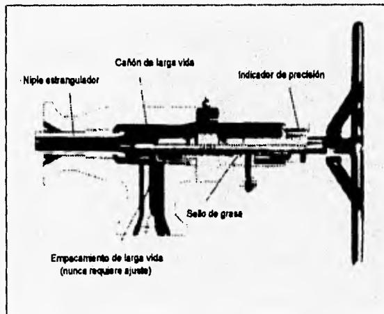
**Fig. 35 Estrangulador Positivo<sup>24</sup>**
