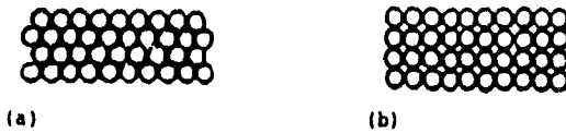
Figura 2.6 Efecto del empaquetado de fibras: (a) Empaquetado hexagonal compacto con 90.8% de vidrio en volumen y 95.6% de fibra en peso; (b) El empaquetado cuadrado tiene arriba del 78.5% de vidrio en volumen y 88.8% en peso.
