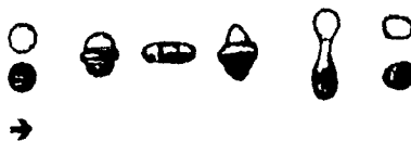
fig.2-12. Muestra de una colisión de separación reflexiva.
