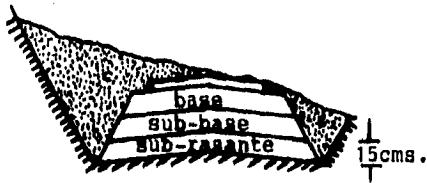
fig.II.2 terracería en corte
