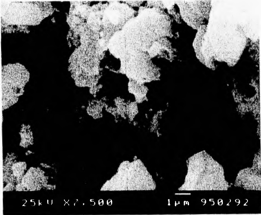
Figura 4.8 Micrografía en la que se observan cristales característicos de la calcita. Como se observó en difracción de Rayos X [cap. III] y por PIXE [cap. V], en que las muestras de techo contienen altas concentraciones de calcita. Estos resultados se corroboran por la gran cantidad de estructuras que son similares a los cristales de calcita.
