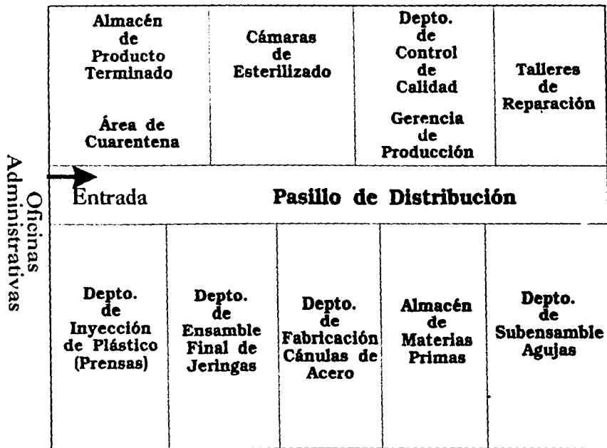
Cuadro 8.2 Distribución de planta antes de automatizar.
