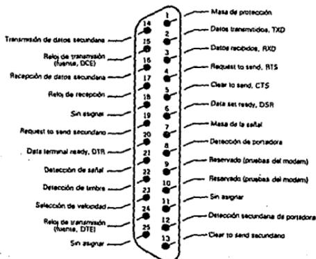
*La disposición más común de una interfaz RS232C de microprocesador utiliza seis líneas de señal y dos conexiones de masa. En esta interfaz se utilizan las funciones de las patillas 1 a 7 y de la 20 del conector D, suponiendo que estamos contemplándolo desde el lado de la computadora. Dichas funciones son las siguientes:*
