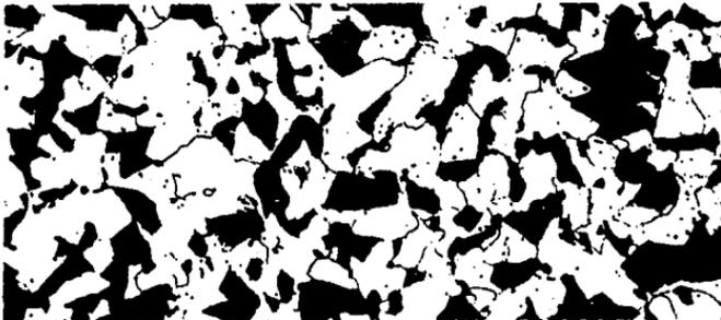
Figura 1.3.- Las zonas blancas muestran la microestructura correspondiente a la ferrita y las zonas oscuras a la perlita (ferrita + cementita).
