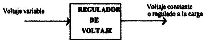
Figura 3.2 Regulador de voltaje.
