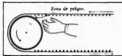
Lesión ocasionada por una cadena que pasa sobre una rueda impulsora.
