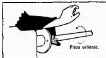
Enrollamiento de ropas sueltas sobre una pieza saliente en giro
