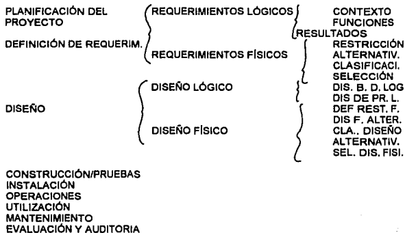
figura 3.3.32 representación de la metodologías de desarrollo de sistemas por medio de un diagrama de Warnier-Orr.
